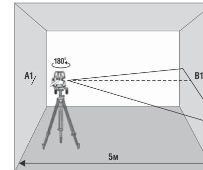
2. Поверните прибор влево, затем вправо, измерьте отклонение оси луча от отметки B1. Если отклонение превышает 2 мм – обратитесь в сервисный центр.
