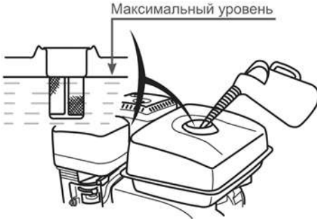
Рис. 9 Максимальный уровень топлива в топливном баке
